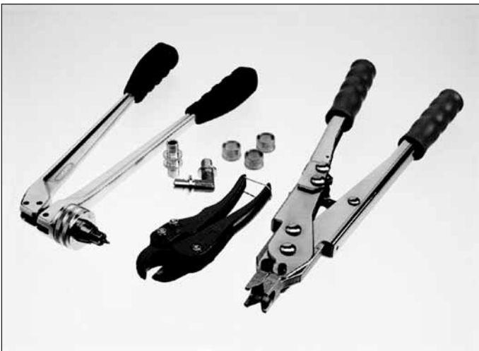
Zestaw narzędzi ręcznych do połączeń aksjalnych TECEflex®
