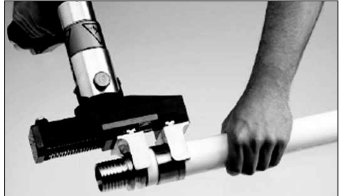
Nasuwanie tulei \phi 50 mm na złącze
